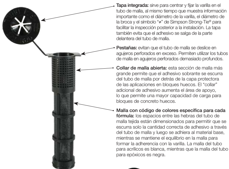
Tubo de malla para adhesivos epóxicos (malla negra)
