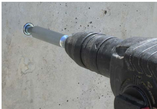
Inserción del anclaje con la herramienta de inserción SDS.
